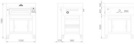
1 CAMERA - CELLA DI LEVITAZIONE ALTA 1 DECK - HIGH PROVER
